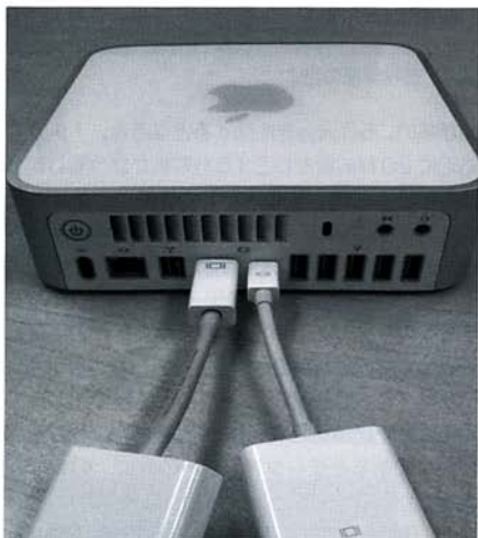
図6 小型PC (Mac mini)の2系統のビデオ出力
